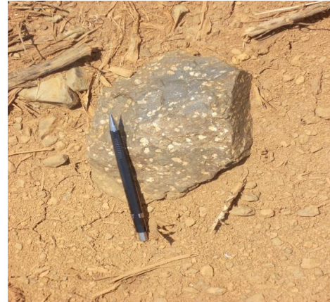
Figura 2.3.1.1-10: Bloco de diabásio, amigdaloidal, procedente da parede do dique. As amígdalas são esses grãos brancos dispersos na rocha. São o resultado do resfriamento rápido e a consequente cristalização dos gases do magma em contato com as paredes frias da rocha sedimentar encaixante.
