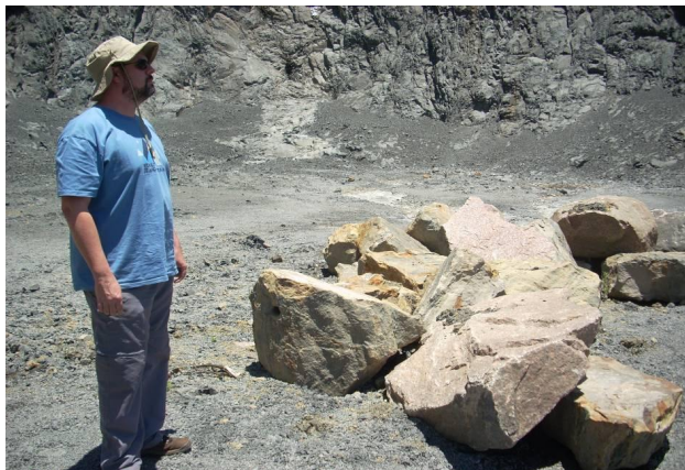
Figura 2.3.1.1-17: Matakão de granito rosa que estava imerso no diabásio e foi separado do diabásio durante a exploração. Por ser extremamente duro e necessitar de beneficiamento (britagem) em separado não é utilizado junto com o diabásio. Observar outros blocos de formas e dimensões variadas no pé da frente de lavra.
