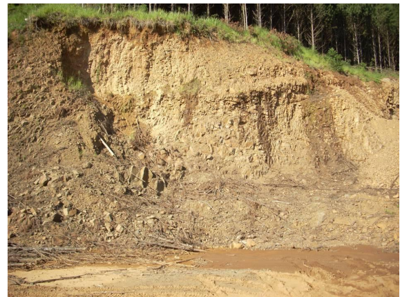
Figura 2.3.1.1-12: Frente de lavra suspensa temporariamente. É reativada conforme as necessidades de revestimento das estradas de terra. O diabásio se apresenta geralmente fragmentado, facilitando a sua extração (lavra) e despesa de britagem. A coloração clara é devida ao intemperismo.
