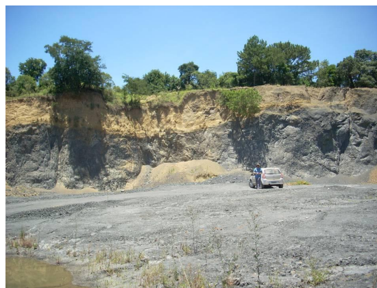
Figura 2.3.1.1-14: Frente da pedreira de diabásio, que é explorada conforme as necessidades de manutenção das estradas. Notar a pequena espessura de estéril (solo), aspecto positivo nesse tipo de mineração.
