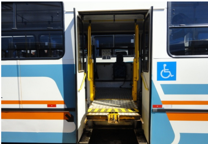
Figura 2.3.3.12-14 – Detalhe do elevador no ônibus adaptado em Telêmaco Borba. Fonte: Pesquisa de campo.
